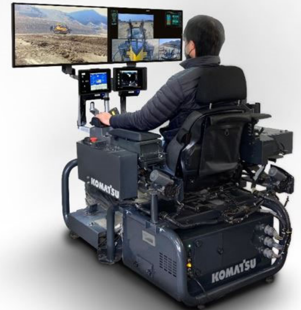
今回新規開発した 遠隔操作用コンソール
